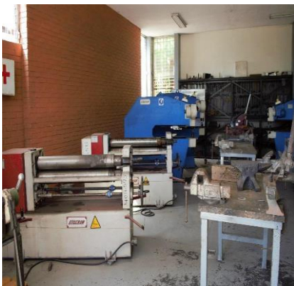
Taller de Mecánica básica y metalistería, máquinas cilindradoras, cizalladoras intermitentes
