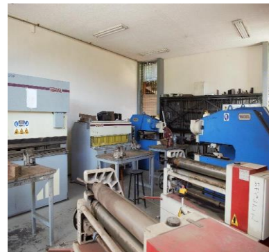
Taller de Mecánica básica y metalistería, máquinas cilindradoras, cizalladoras intermitentes
