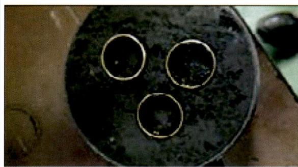
En la ilustración 3 podemos observar las variaciones físicas que provoca la cal en el suelo. Ambos especímenes fueron fabricados con la humedad óptima del suelo, pero con variación del porcentaje de cal añadida.
